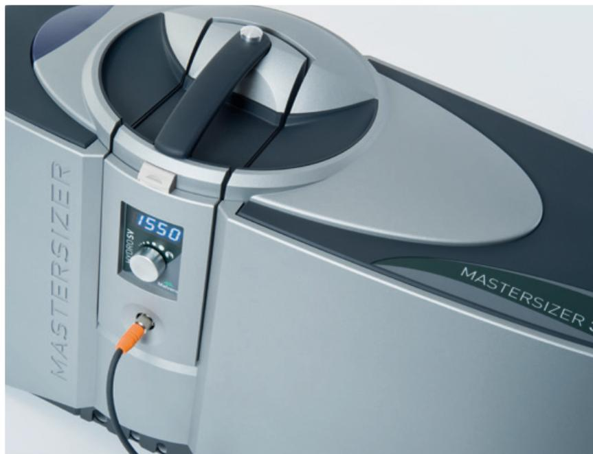
L'Hydro SV est une unité de dispersion simple et économique conçue pour permettre l'analyse granulométrique de petits volumes d'échantillon et de dispersant. Il est particulièrement utile lorsque la quantité d'échantillon disponible pour l'analyse est très limitée, ou lorsque l'utilisation de solvant nécessaire pour mesurer l'échantillon présente des risques avérés pour la santé ou l'environnement.
