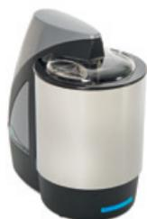
**Hydro LV** - C'est un système de dispersion automatisé de grand volume adapté aux applications où la disponibilité de l'échantillon n'est pas un problème ou lorsque des volumes plus grands sont nécessaires pour assurer un bon échantillonnage.
