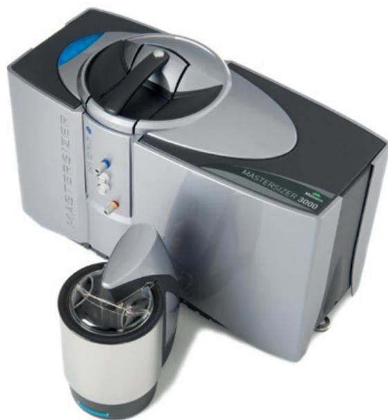
L'Hydro LV est prévu pour des applications utilisant des matériaux disponibles en quantité suffisante. Il permet de mesurer de grosses particules et des distributions étendues sur des volumes d'échantillonnage importants qui seront suffisamment représentatifs.
