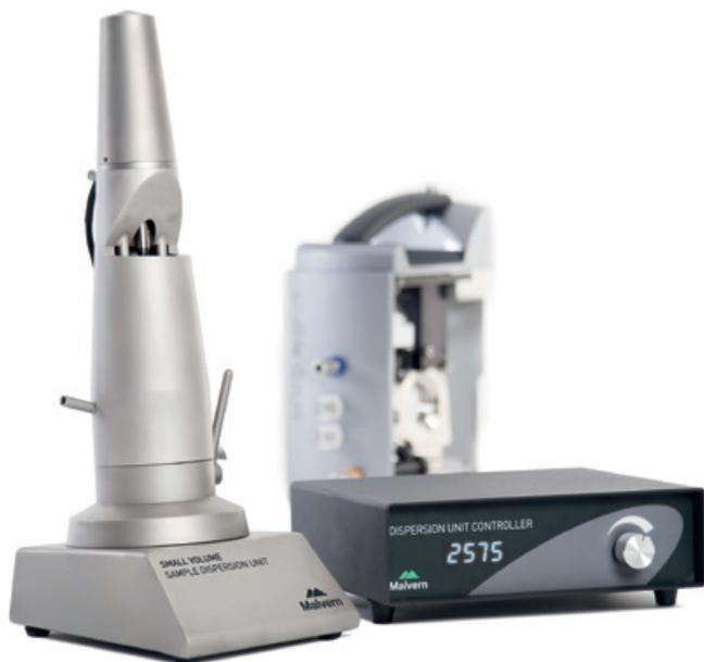
L'Hydro est un accessoire économique de dispersion d'échantillons en voie liquide, conçu pour mesurer des échantillons dans des dispersants non aqueux où l'utilisation de solvants doit être réduite au minimum.
