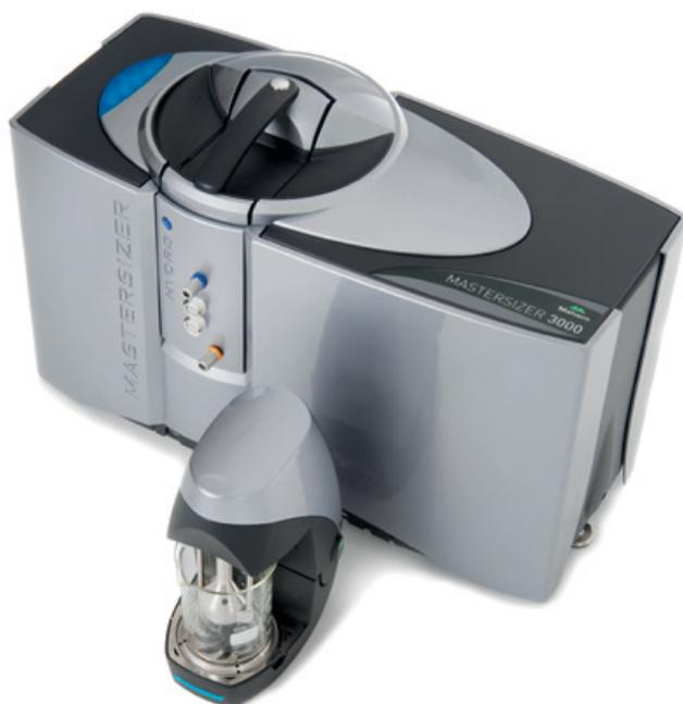
L'Hydro EV est unique en son genre. Grâce à l'association d'une pompe centrifuge et d'un agitateur (à immersion), l'échantillon se disperse rapidement et en totalité dans des béchers standard, ce qui permet d'adapter le volume de dispersant plus précisément à l'application. Une fois la mesure accomplie, la tête de dispersion peut être sortie du bécher pour être nettoyée et récupérer l'échantillon.
